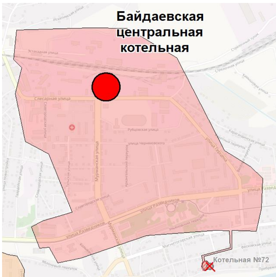
Рисунок 10.4 – Зона теплоснабжения БЦК, перспектива
